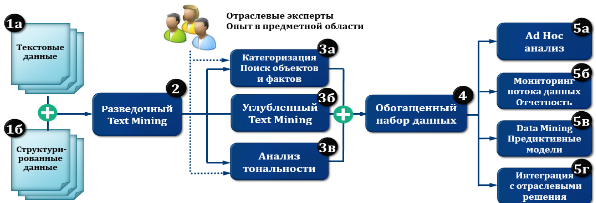
Рис. Типовая функциональная архитектура системы текстовой аналитики
