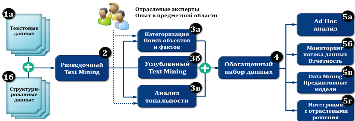
Рис. Типовая функциональная архитектура системы текстовой аналитики
