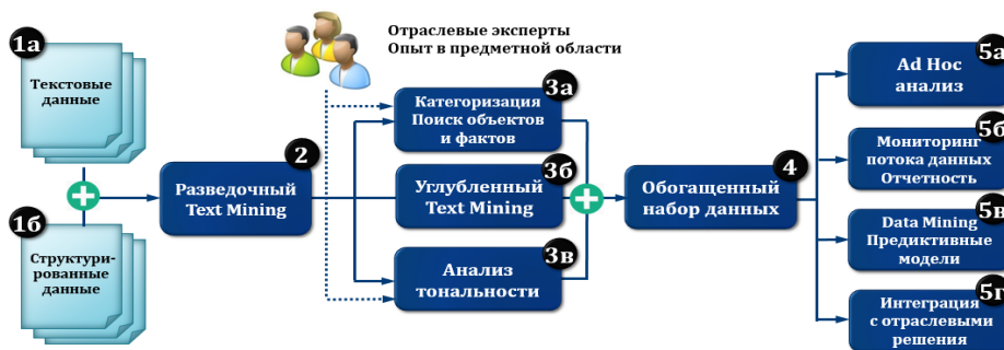
Рис. Типовая функциональная архитектура системы текстовой аналитики
