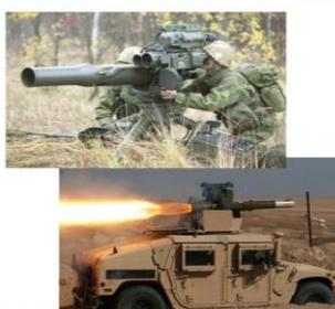
ПТУР «Тоу» («Дракон») имеет кумулятивную боевую часть и цилиндрический корпус. Дальность стрельбы составляет 3750 м (1000 м), бронепробиваемость - 500 мм (430 мм). Стрельба может вестись с наземной (переносной) и самоходной пусковых установок. Система управления - полуавтоматическая с инфракрасной аппаратурой слежения за снарядом и передачей команд по проводам.
