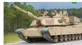
Танки М1 «Абрамс» со 105-мм пушкой и М1А1 «Абрамс» со 120-мм гладкоствольной пушкой, имеют многослойную броневую защиту, оснащены лазерным дальномером, бесподсветочными ночными приборами, электронным баллистическим вычислителем, системой стабилизации пушки в двух плоскостях, навигационной аппаратурой.
