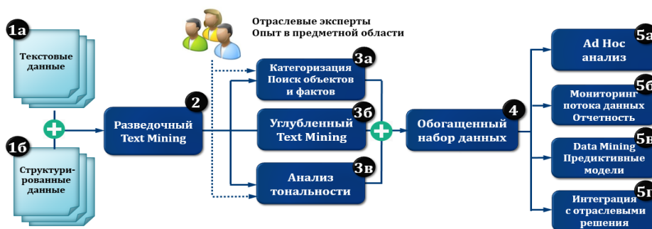
Рис. Типовая функциональная архитектура системы текстовой аналитики
