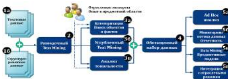
Рис. Типовая функциональная архитектура системы текстовой аналитики
