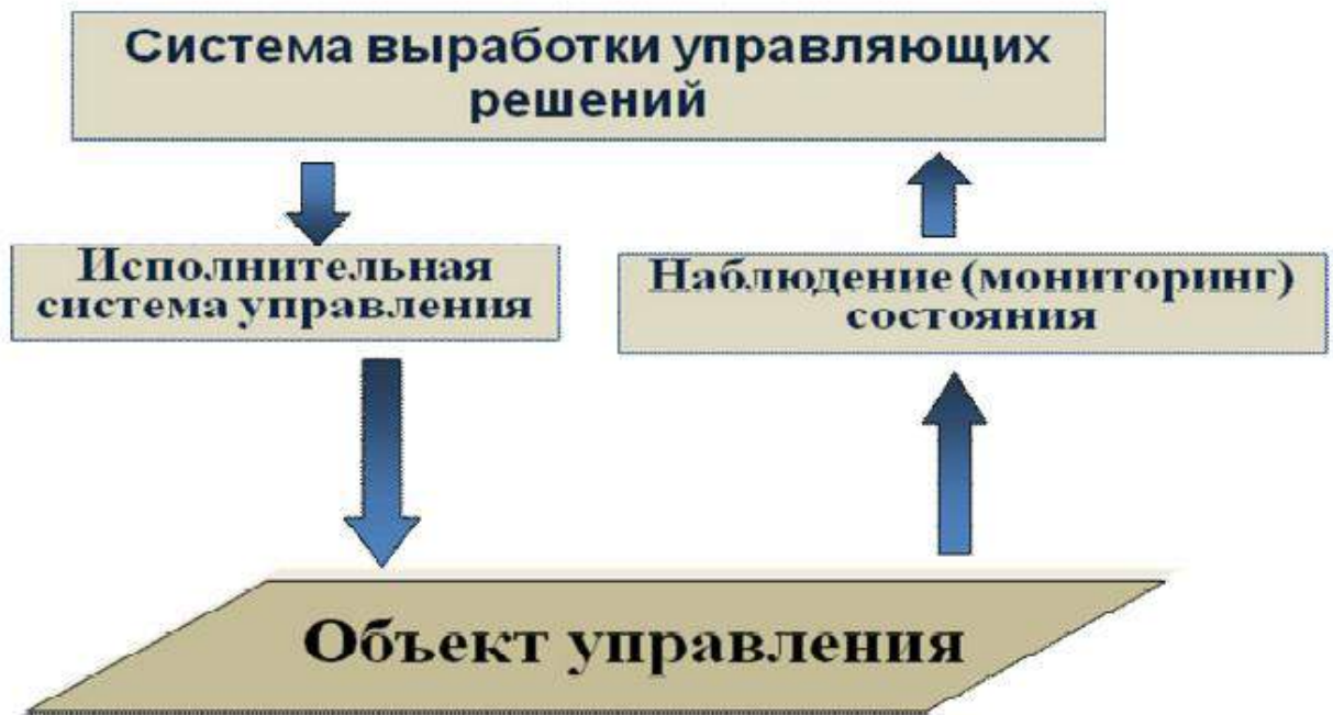
Рис. Общая схема управления с явно выделенной системой выработки управляющих решений
