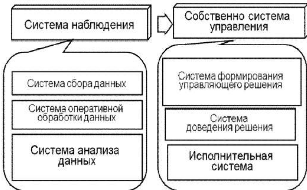
Рис. Традиционная модель управления по Винеру
