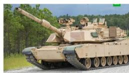
Танки М1 «Абрамс» со 105-мм пушкой и М1А1 «Абрамс» со 120-мм гладкоствольной пушкой, имеют многослойную броневую защиту, оснащены лазерным дальномером, бесподсветочными ночными приборами, электронным баллистическим вычислителем, системой стабилизации пушки в двух плоскостях, навигационной аппаратурой.
