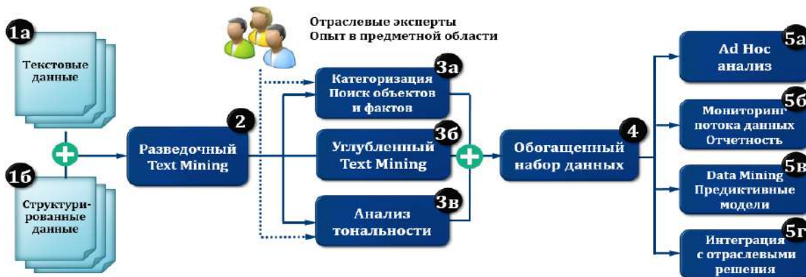
Рис. Типовая функциональная архитектура системы текстовой аналитики
