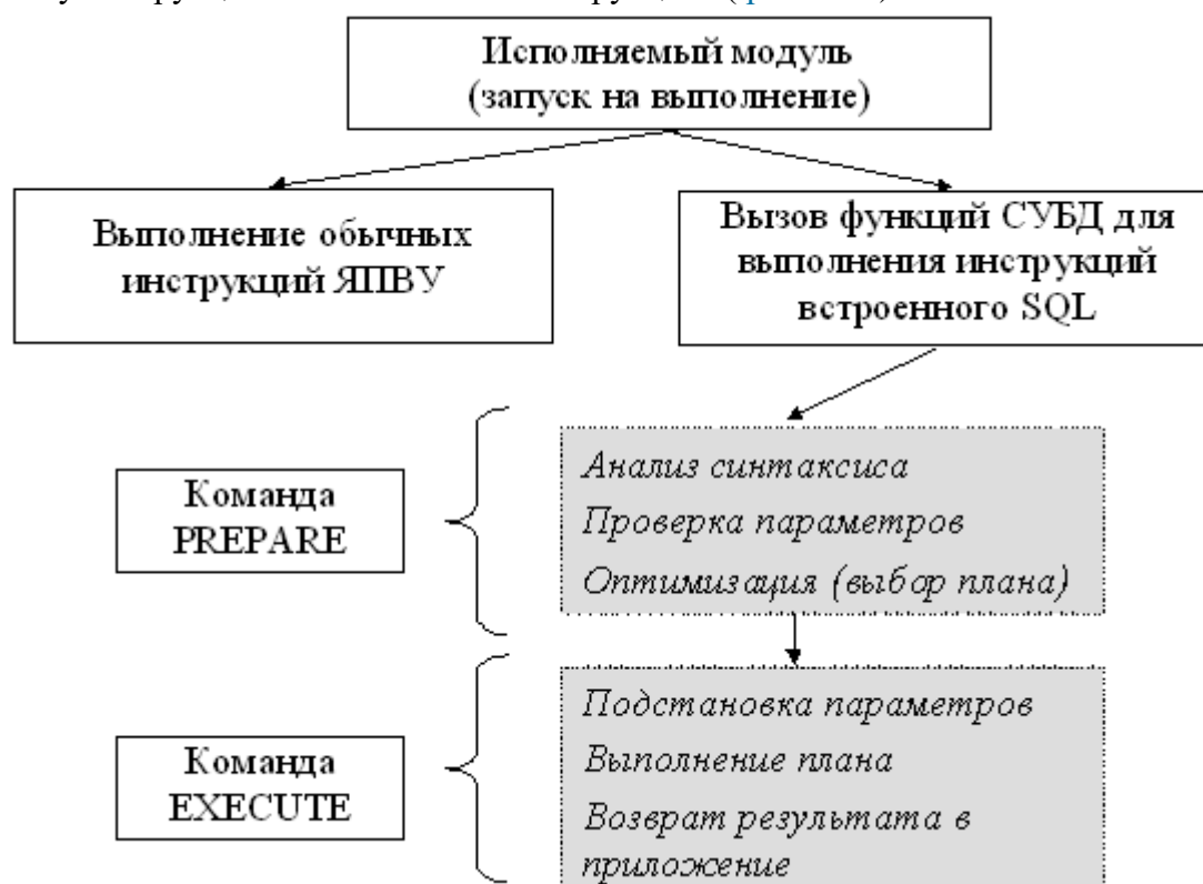
Рис. 13.4. Схема выполнения программы со встроенными инструкциями динамического SQL с применением двухэтапной схемы
