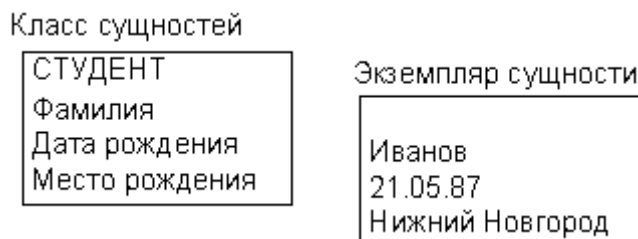
Рис. 5.1. Класс сущностей и экземпляр сущности
