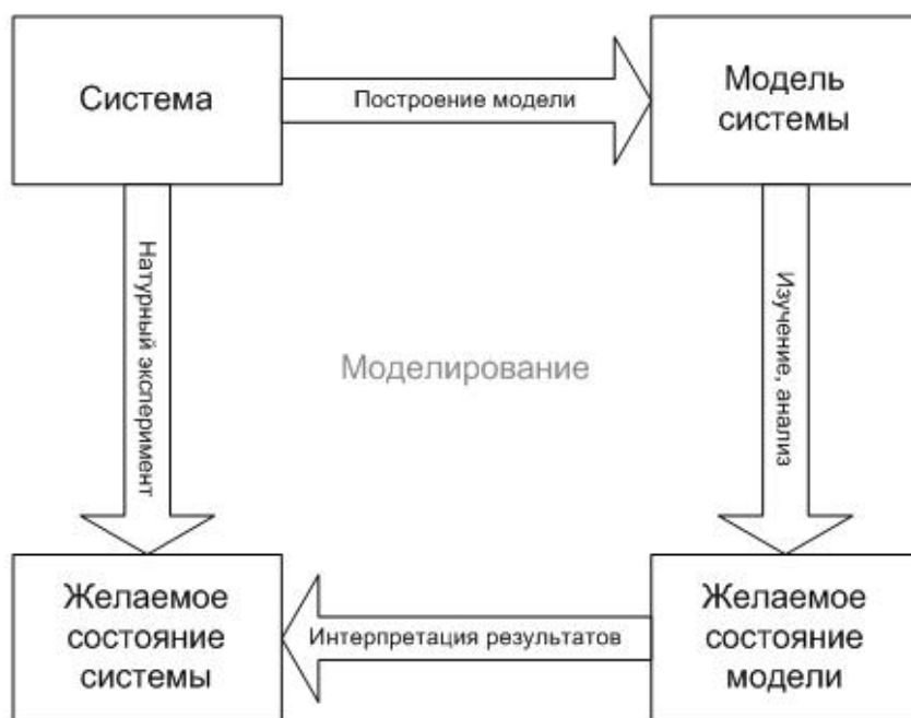
Схема. Процесс моделирования системы.
