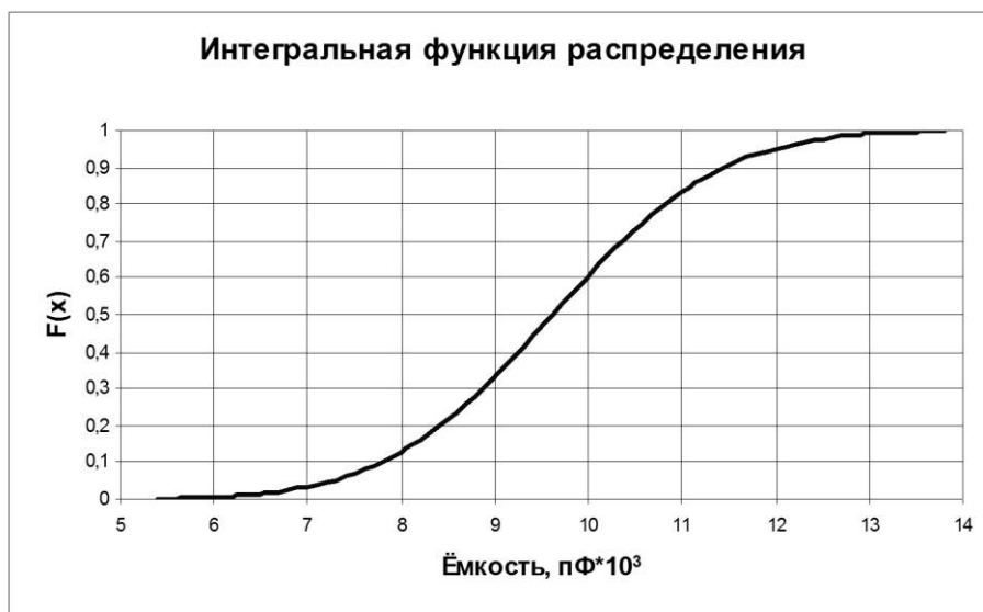
Рис. 1.2. Интегральная функция распределения ёмкости пластин пьезоэлементов
