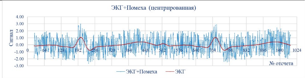
Рис. 1. Сигнал ЭКГ при наличии широкополосной помехи. Спектр мощности широкополосной помехи показан на рисунке 2. Частотное разрешение сигнала составляет 1 Гц.
