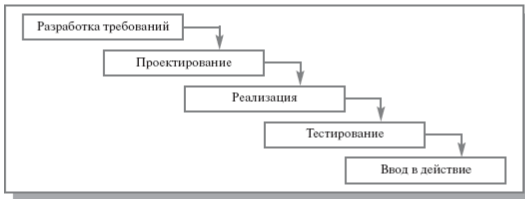
Рисунок 2. Каскадная модель жизненного цикла информационной системы управления.
