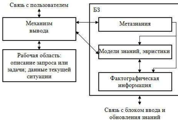
Структура взаимодействия БЗ с основными компонентами ИИС для продукционных систем
