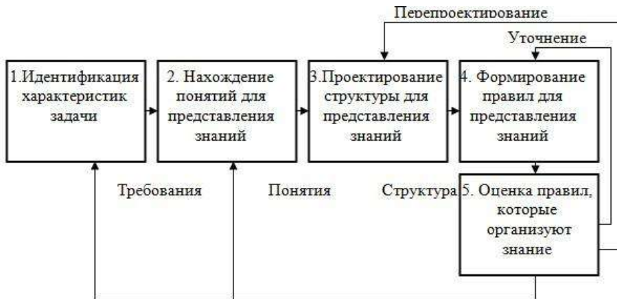
Рисунок 3. Процесс построения систем ИИ
