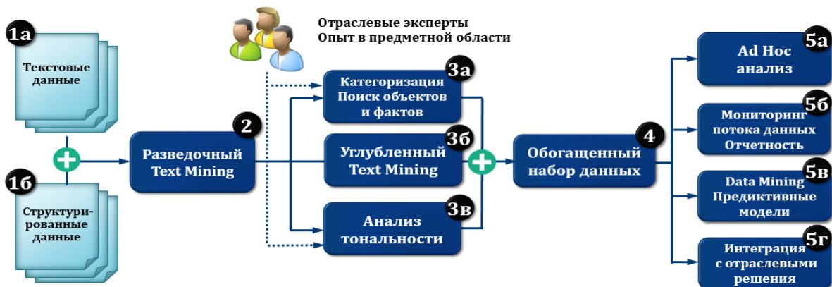
Рис. Типовая функциональная архитектура системы текстовой аналитики
