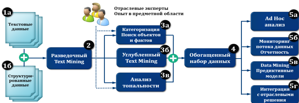
Рис. Типовая функциональная архитектура системы текстовой аналитики
