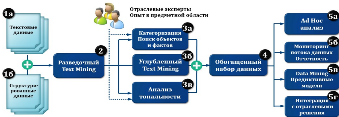
Рис. Типовая функциональная архитектура системы текстовой аналитики
