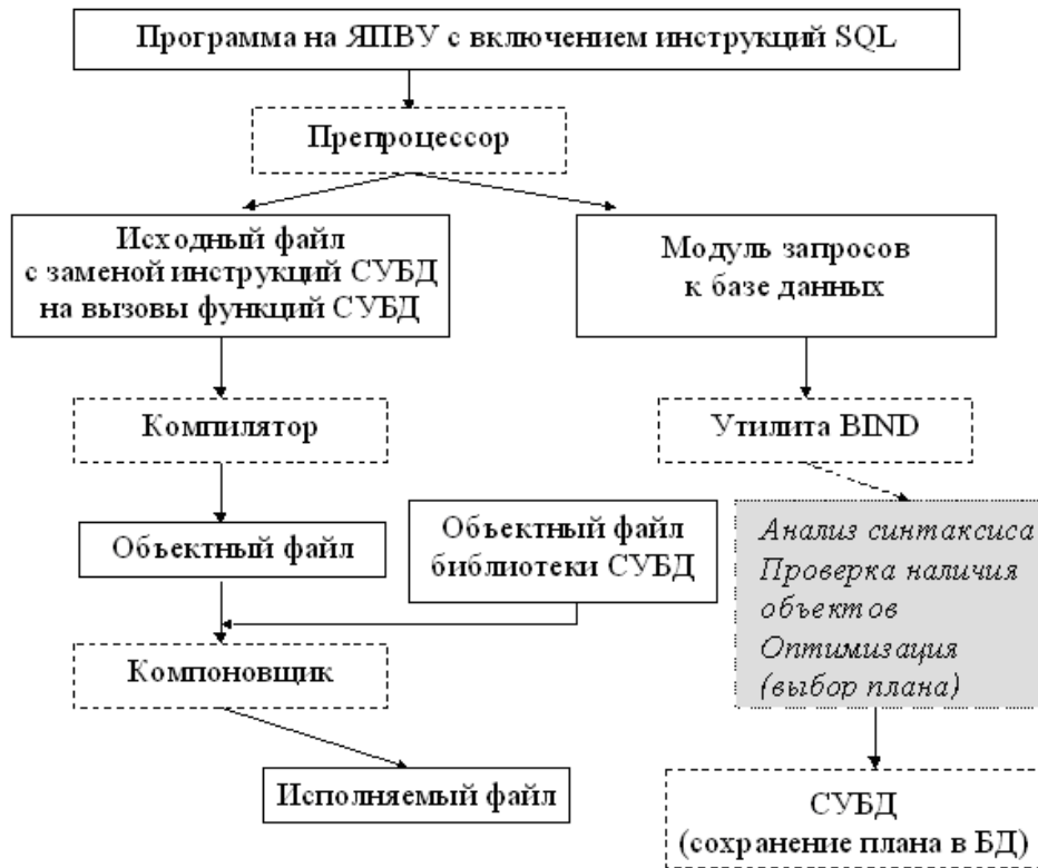
Рис. 13.1. Схема компиляции программы с встроенными инструкциями статического SQL
