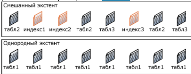
Рис. 10.2. Размещение объектов в смешанном и однородном экстенентах
