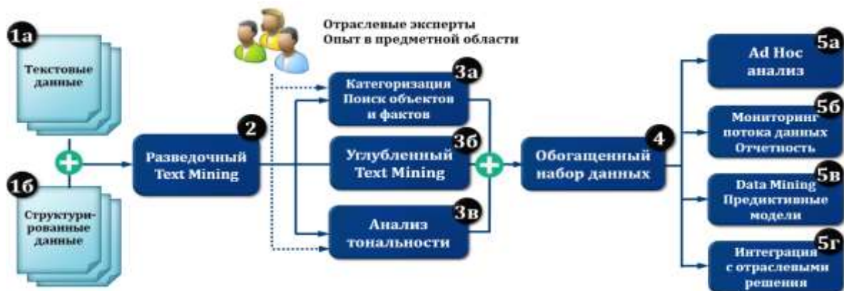
Рис. Типовая функциональная архитектура системы текстовой аналитики
