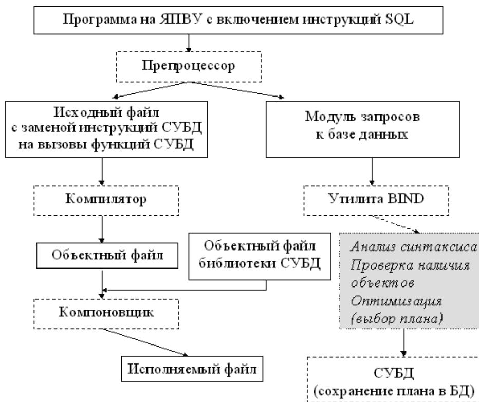
Рис. 13.1. Схема компиляции программы с встроенными инструкциями статического SQL
