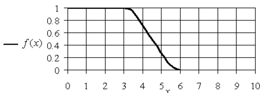
Рис. 1.10. График Z-образной функции принадлежности f_{z_1} Для значений параметров А = 3, В = 6
