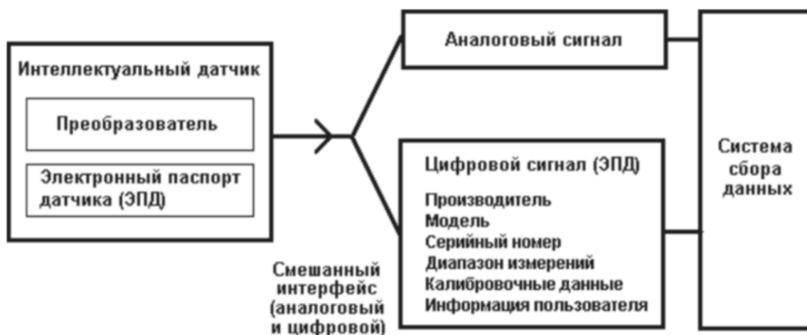
Рис. Смешанный интерфейс TEDS-датчиков
