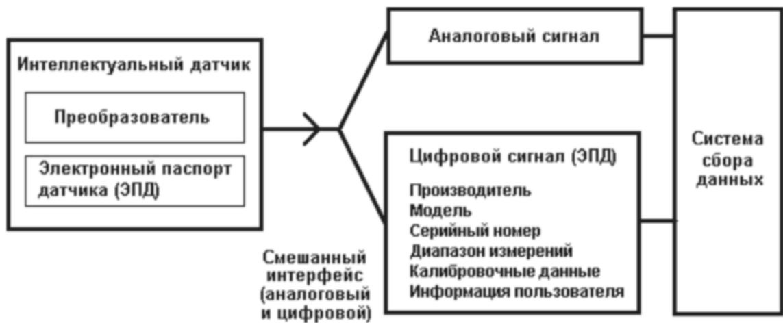
Смешанный интерфейс TEDS-датчиков
