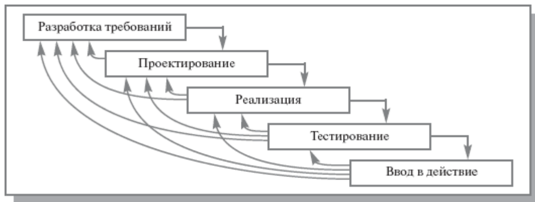
Рисунок 3. Поэтапная модель жизненного цикла информационной системы управления с промежуточным контролем.
