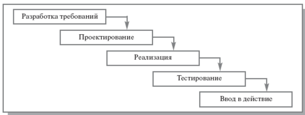
Рисунок 2. Каскадная модель жизненного цикла информационной системы управления.
