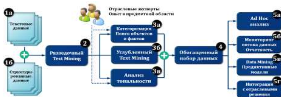
Рис. Типовая функциональная архитектура системы текстовой аналитики
