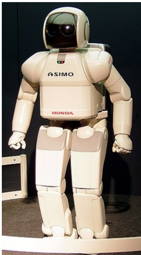
Рис. ASIMO — интеллектуальный гуманоидный робот фирмы Honda
