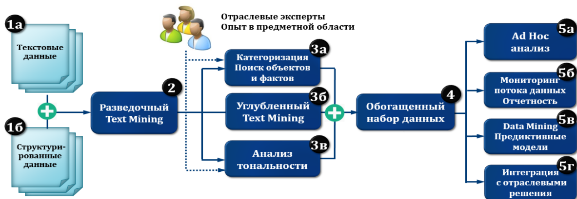
Рис. Типовая функциональная архитектура системы текстовой аналитики
