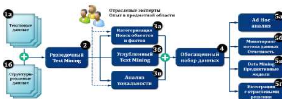
Рис. Типовая функциональная архитектура системы текстовой аналитики
