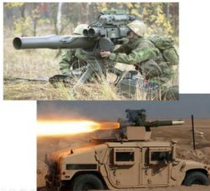
ПТУР «Той» («Дракон») имеет кумулятивную боевую часть и цилиндрический корпус. Дальность стрельбы составляет 3750 м (1000 м), бронепробиваемость – 500 мм (430 мм). Стрельба может вестись с наземной (переносной) и самоходной пусковых установок. Система управления – полуавтоматическая с инфракрасной аппаратурой слежения за снарядом и передачей команд по проводам.
