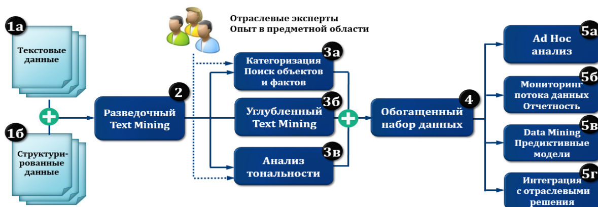
Рис. Типовая функциональная архитектура системы текстовой аналитики
