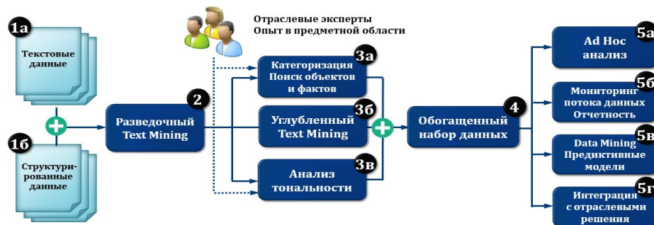
Рис. Типовая функциональная архитектура системы текстовой аналитики
