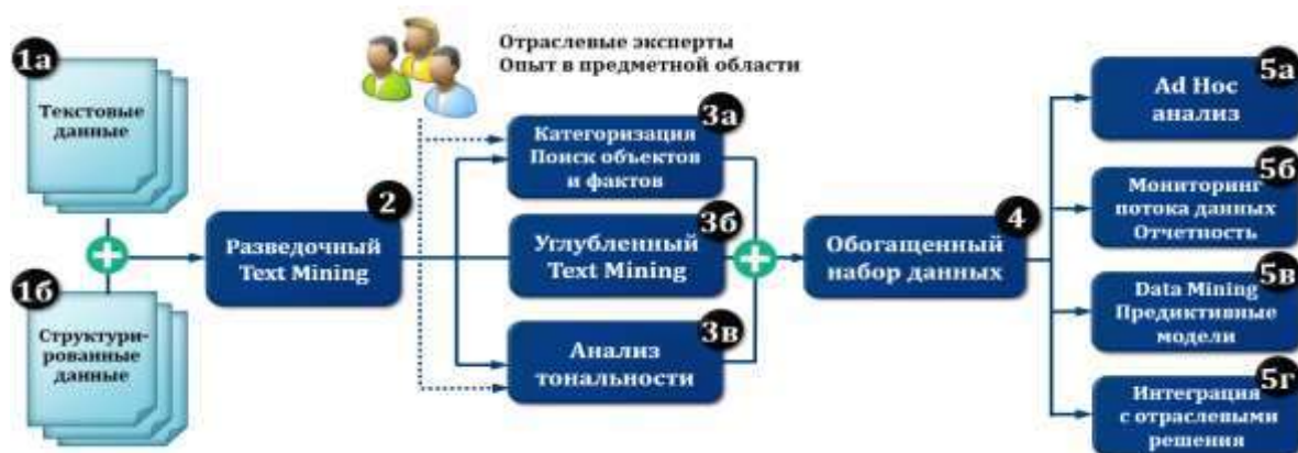
Рис. Типовая функциональная архитектура системы текстовой аналитики
