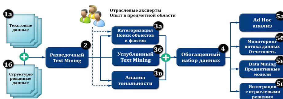
Рис. Типовая функциональная архитектура системы текстовой аналитики
