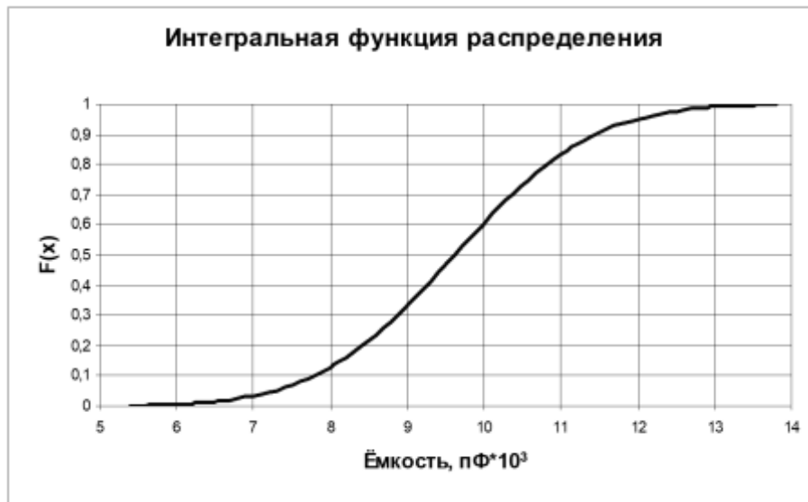
Рис. 1.2. Интегральная функция распределения ёмкости пластин пьезоэлементов
